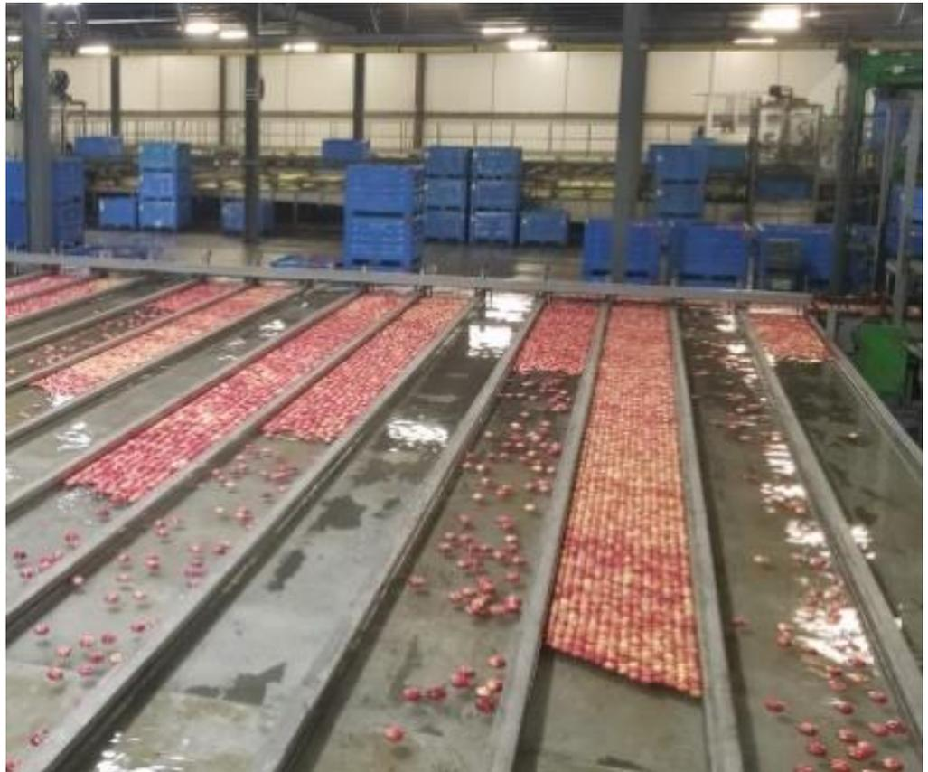
Une station de calibrage des pommes par flottaison dans l'eau pour éviter les chocs.
